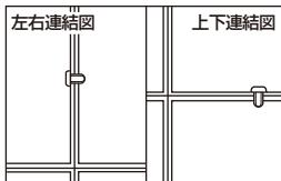
④上下及び左右に隣接する連結穴を利用して、連結用リベット
